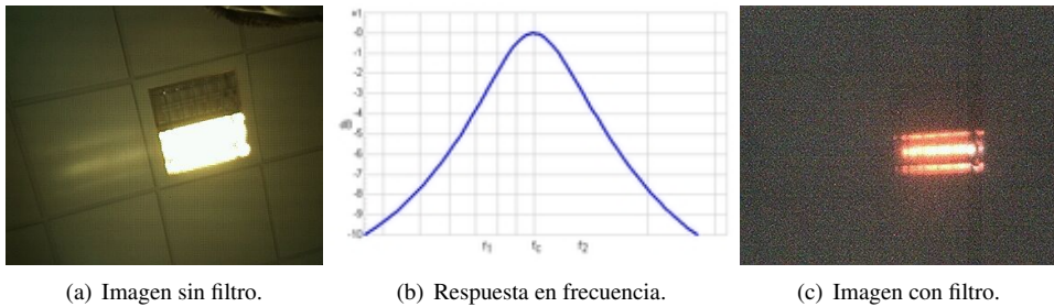
Figura 3.3: Efecto del filtro pasa banda infrarrojo sobre las imágenes.
