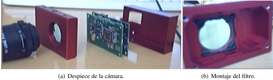
Figura 3.2: Montaje del filtro pasa banda infrarrojo en la cámara MDCS2.
