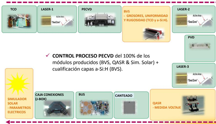
Figura 2.15: Control en línea de la calidad de los procesos de fabricación.
