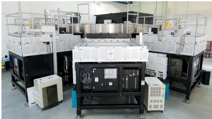
**Figura 2.5:** Fotografía del equipo de deposición PECVD utilizado en la producción industrial de módulos de a-Si:H.
