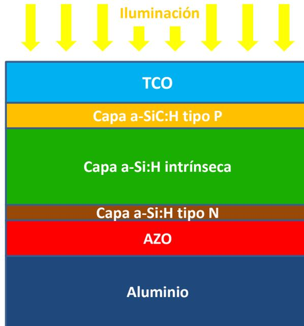
**Figura 5.7:** Esquema de la estructura de una célula solar de a-Si:H usada en la simulación.
