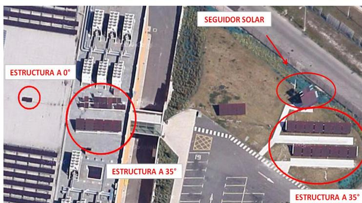
Figura 3.2: Vista aérea de las diferentes estructuras del *Outdoor test station*.
