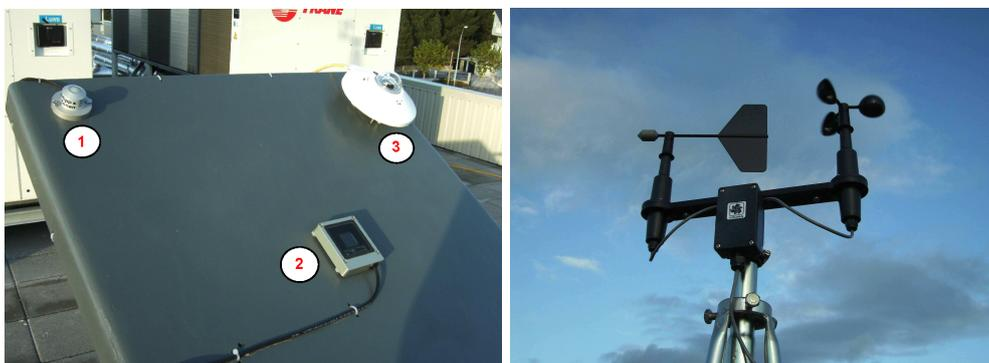
**Figura 3.3:** A la izquierda, sensores de irradiancia: 1.Fotodiodo, 2.Célula de referencia de silicio cristalino filtrada y 3.Piranómetro térmico. A la derecha, sensores meteorológicos: anemómetro de cazoletas y veleta.
