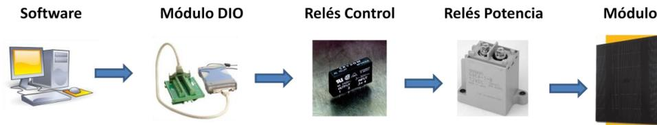
**Figura 3.5:** Esquema con las diferentes etapas de control del *switch*.
