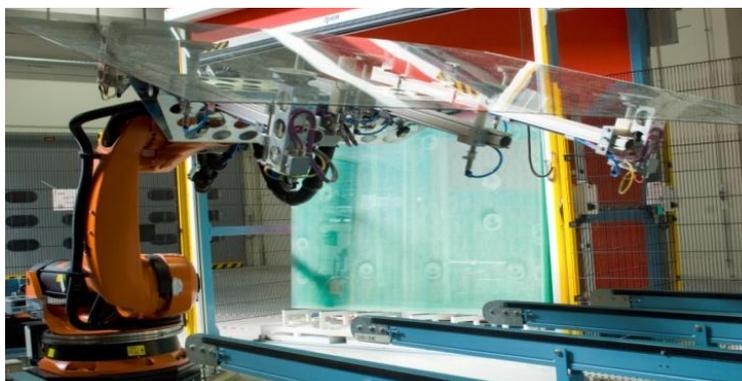
**Figura 2.3:** Material de entrada en la línea: hoja de vidrio de  $5,72 m^2$  con una capa de TCO.
