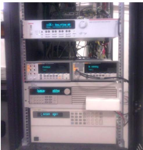
**Figura 3.4:** Armario con los multímetros y cargas electrónicas.
