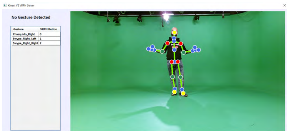
Figura 4.22: Interfaz gráfica implementada para el servidor VRPN asociado al sensor Microsoft Kinect V2
